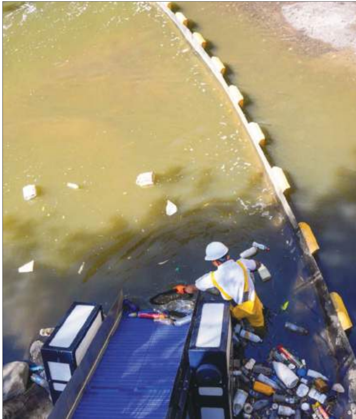
La cinta transportadora es móvil y puede ser desplazada de una barrera a otra según sea necesario.
